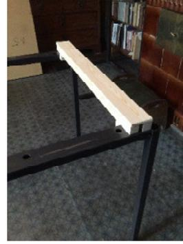
Das Metallgestell mit dem unteren Teil der Trägerkonstruktion sowie dem später die Tischplatte tragenden Brett.
